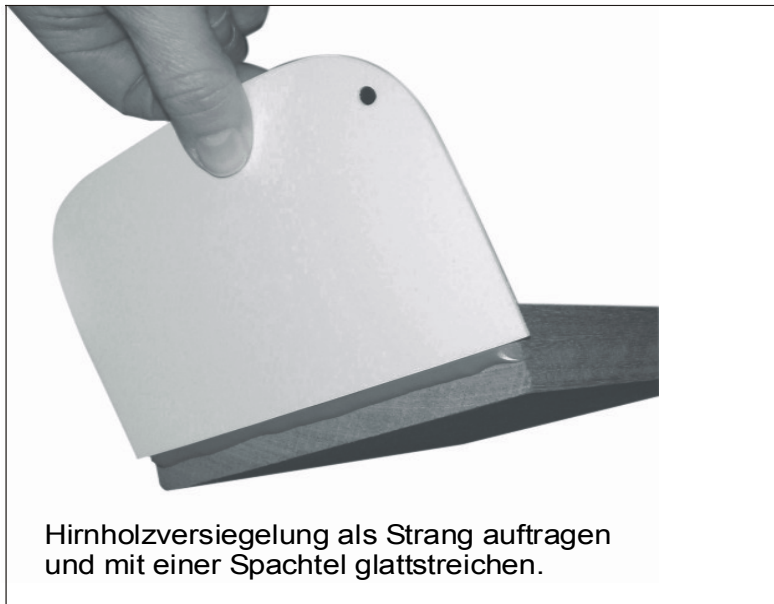
Bild 11: Anwendung der Hirnholzversiegelung
