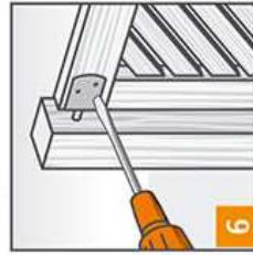
6. Nun können die Zaunelemente an den Zahnhaltern ange- schraubt werden. Verwenden Sie hier für geeignete rostfreie Schrauben.
